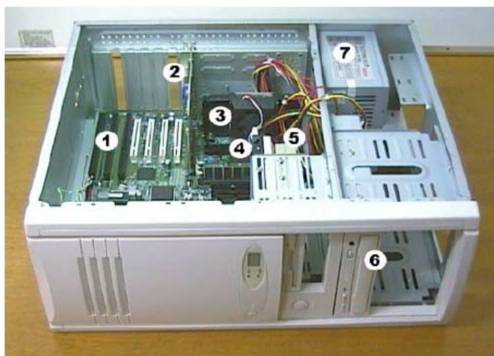
Figura 4.1 - Disposição dos componentes no gabinete ATX
