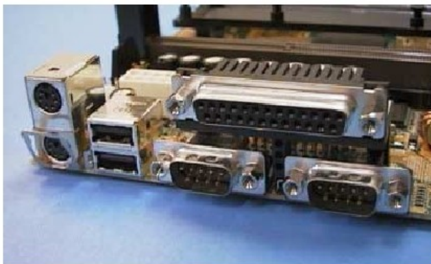
Figura 1.9 Conectores existentes na parte traseira de uma placa de CPU padrão ATX.
