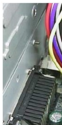
Figura 4.10 Conectando a fonte de alimentação na placa de CPU ATX.
