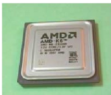
Figura 3.2 Este AMD K6 opera internamente com 3,2 volts.
