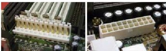
Figura 1.5 Conectores de fonte padrão AT e ATX
