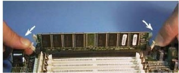
Figura 2.9 Removendo um módulo DIMM/168.
