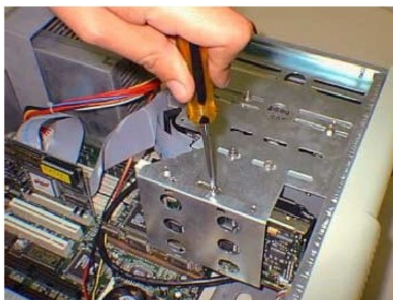
Figura 2.22 Aparafusando o disco rígido no gabinete
