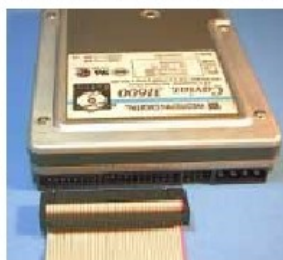
Figura 4.15 Conectando o cabo flat do disco rígido na interface IDE primária da placa de CPU.
