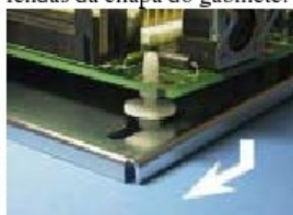
Figura 4.9 - Encaixando os espaçadores plásticos nas fendas da chapa do gabinete:
