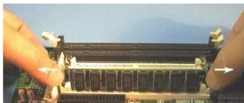
Figura 2.7 Retirando um módulo de memória SIMM
