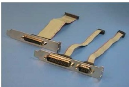
Figura 1.21 Conectores auxiliares para as interface seriais.
